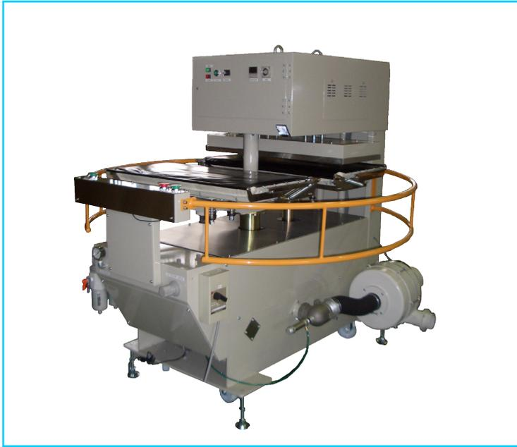
○2面の下ゴテが押しボタン操作で自動反転し、セット・プレスを行います。
