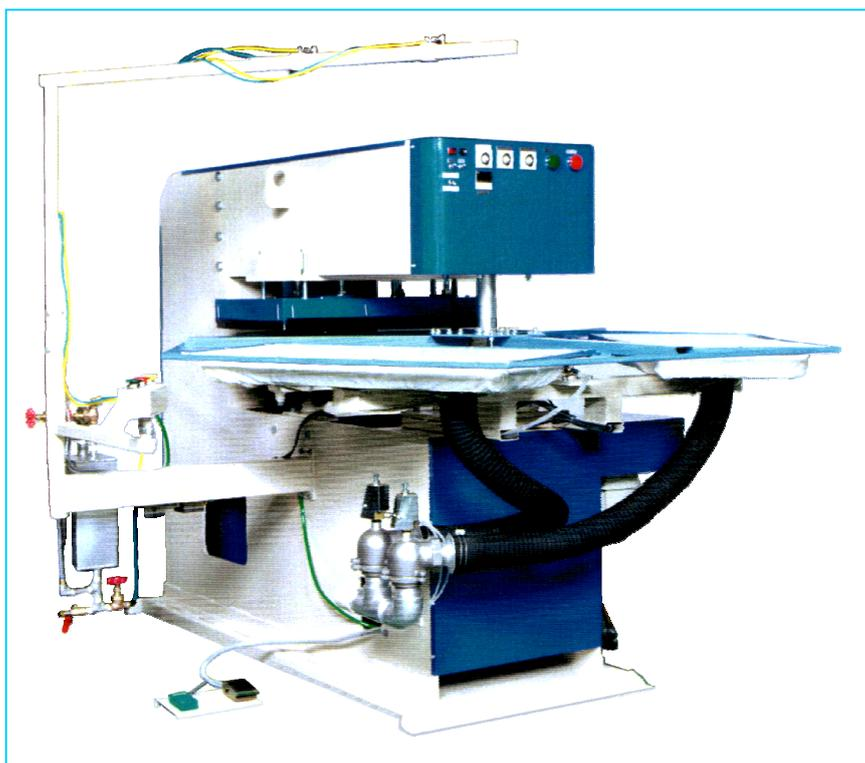
○3面の下ゴテが押しボタン操作で自動回転し、セット・プレス・冷却を行います。加熱ゴテとは別に水冷式の冷却ゴテを設けてあり、熱接着後直ちに冷却する事でより完全なものとしています。
